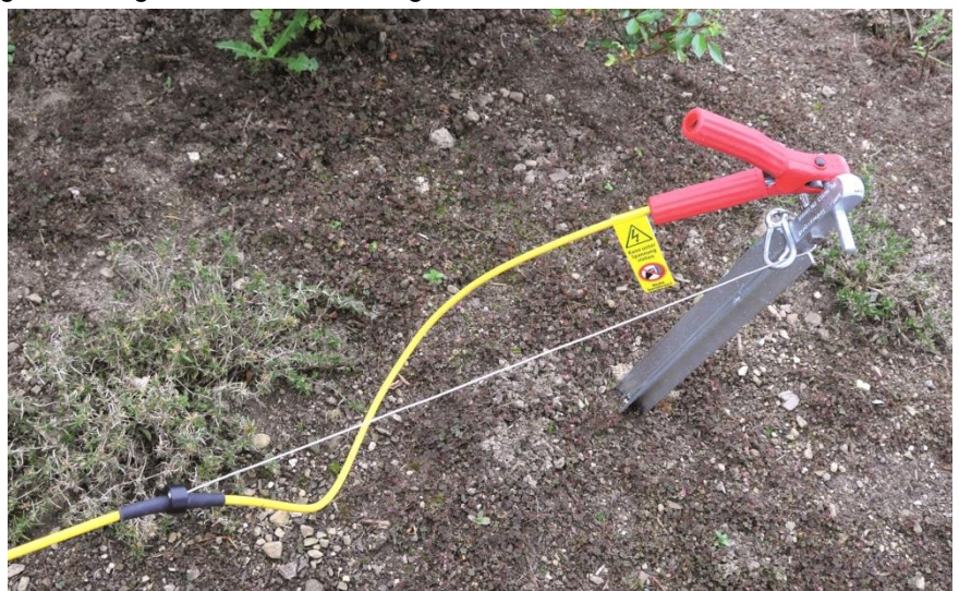
Erdung mit einem Erdungsspieß
