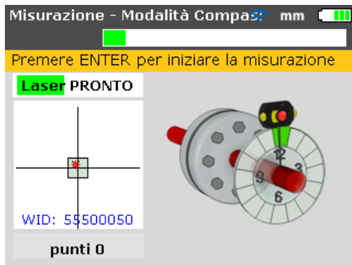
Figura 6-3. Centraggio del raggio laser riflesso utilizzando la rotella e il pomello giallo di regolazione del raggio
