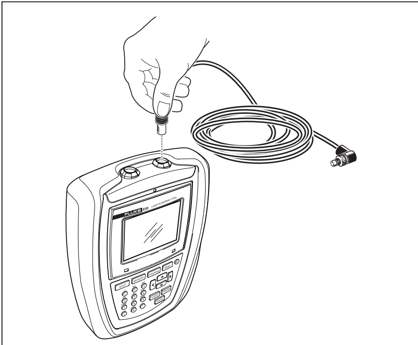
Figura 7-5. Inserimento del cavo del sensore nel dispositivo di allineamento
